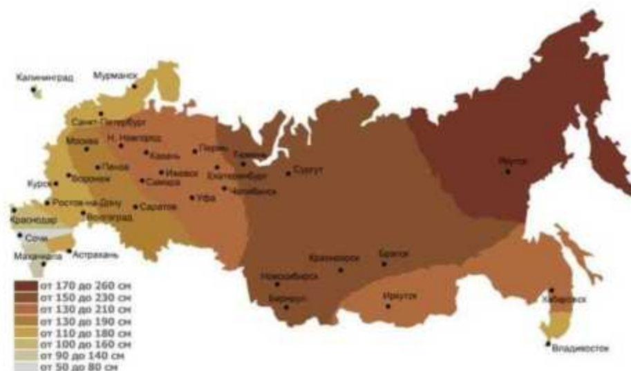
Рис. 2. Изменение глубины промерзания грунта по территории РФ
