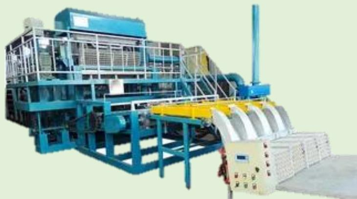
Машина изготавливающая лотки для яиц модель Pf-f3000. Отливает и прессует формы для яиц из подготовленной массы (пульпы). Производительность: 3-5 тысяч лотков в час.
