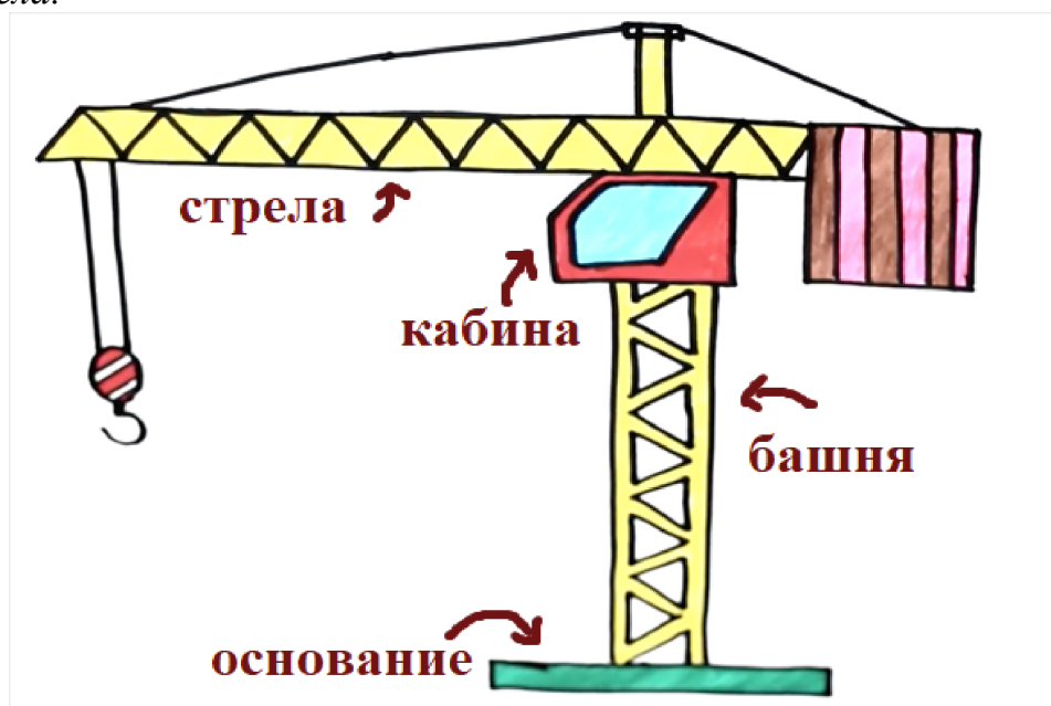
Рисунок 2. Схематичное устройство подъёмного крана
